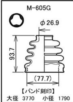
図中の寸法は、ブーツ組付け時の寸法(参考値)です。
