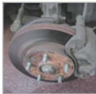
① 作業できる安全な場所に車を止め、確実に車体を上げ、ホイールを取り外す。
