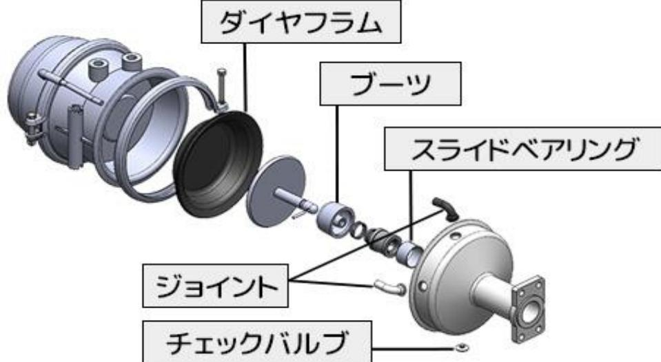
ゴム製部品などが劣化・摩耗すると、エアもれが発生し、ブレーキの作動不良や引きずりを起こす原因となります。
