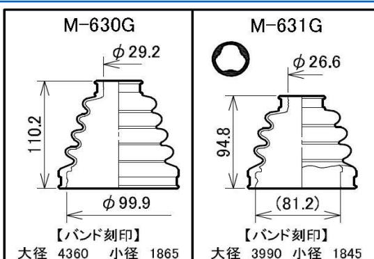
図中の寸法は、ブーツ組付け時の寸法(参考値)です。
