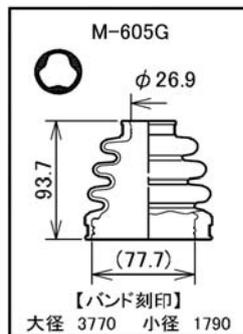
図中の寸法は、ブーツ組付け時の寸法(参考値)です。
