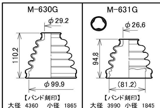
図中の寸法は、ブーツ組付け時の寸法(参考値)です。
