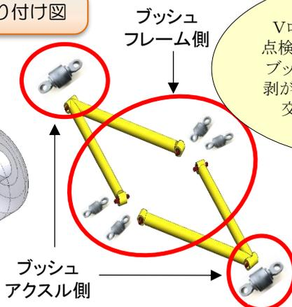
Vロッドは3ヶ月及び12ヶ月点検の対象となっております。ブッシュの亀裂・摩耗・変形・剥がれの確認を行い、早めの交換をお願い致します。
