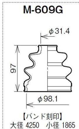
図中の寸法は、ブーツ組付け時の寸法(参考値)です。
