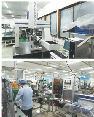
写真上: 部品の測定・検査を実施 写真下: 組立製品を全数検査!
