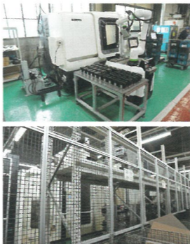
写真上: 人の代わりに材料の供給と加工品の排出を実施(省人化) 写真下: 材料と治具を載せて自動搬送(省力化)
